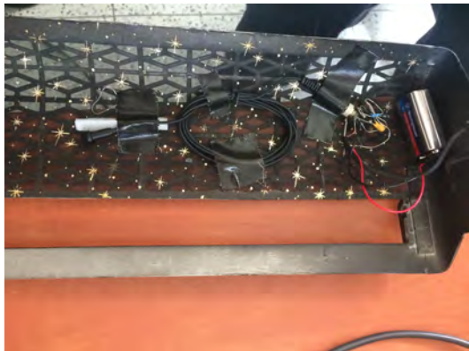
Obr. 8 Sennheiser ME 2-II na krytu diskantové části, fotografie
