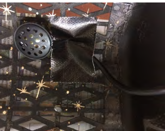
Obr. 5 Větší dynamické sluchátko na krytu diskantové části, fotografie
