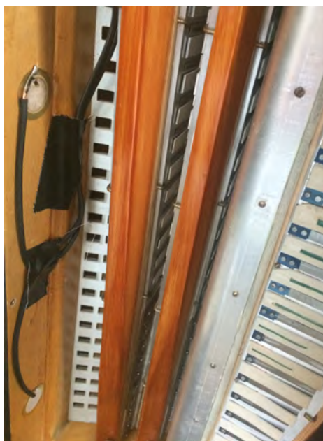
Obr. 3 Umístění piezoelektrických snímačů uvnitř diskantové části nástroje, nákras
