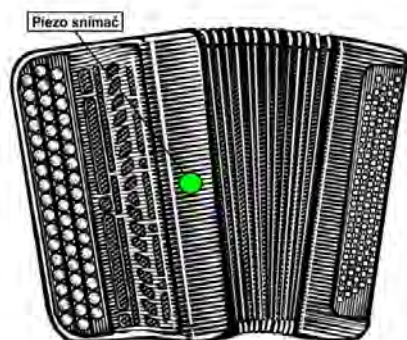
Obr. 3 Umístění piezoelektrických snímačů uvnitř diskantové části nástroje, nákras
