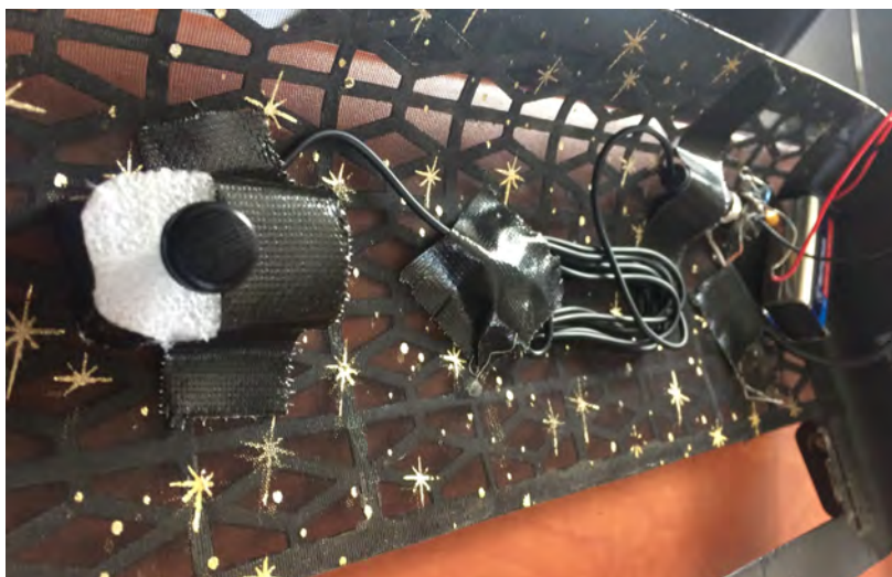
Obr. 12 Sennheiser ME 4-N na krytu diskantové části, fotografie
