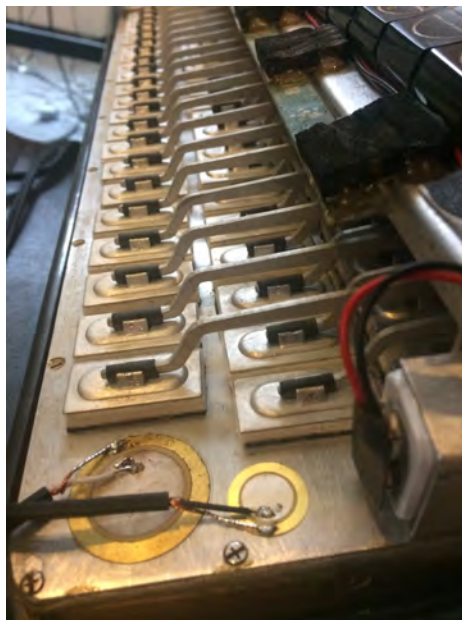
Obr. 1 Umístění piezoelektrických snímačů, nákras
