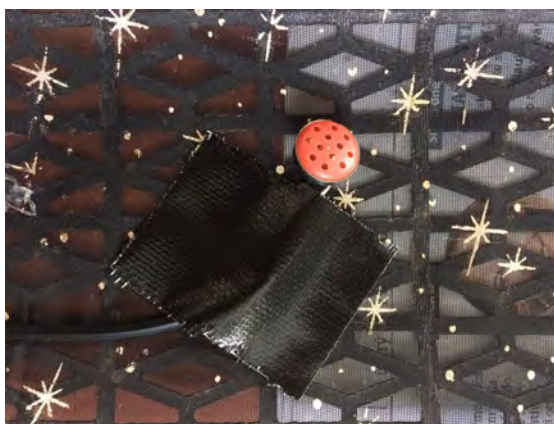
Obr. 6 Menší dynamické sluchátko na krytu diskantové části, fotografie
