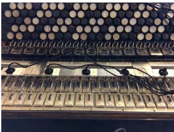
Obr. 23 Pět kardioidních mikrofonů Sennheiser ME 4-N na diskantové části, fotografie
